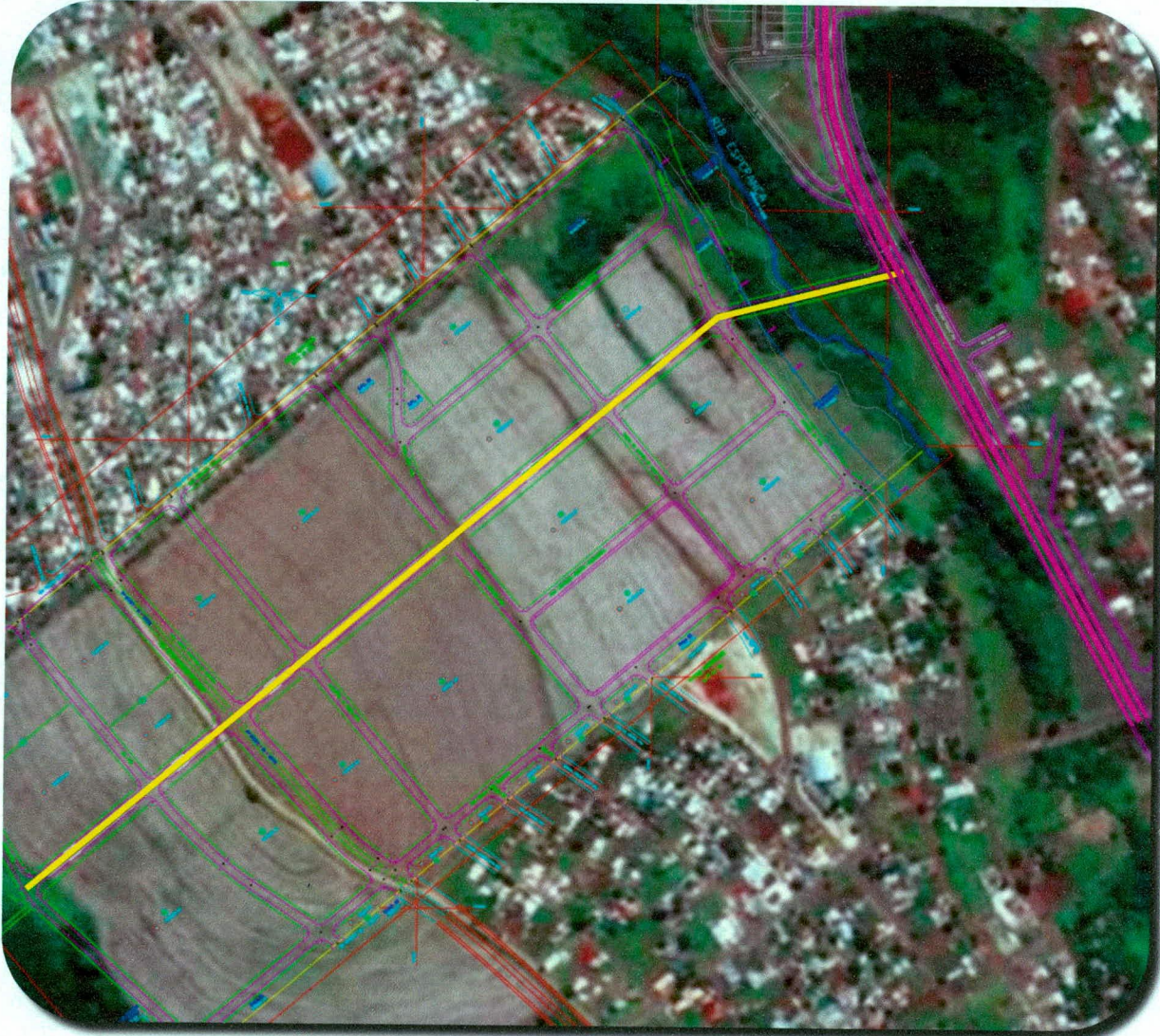
Figura 5.9. Ligação da Rua José Alves Nunes (Via Coletora - em amarelo) com a Av. Juvenal Prietraroia (Parte do Anel de Integração Viária do Município - em rosa). A Planta geral de conexão com o sistema viário será apresentada no Anexo F.
